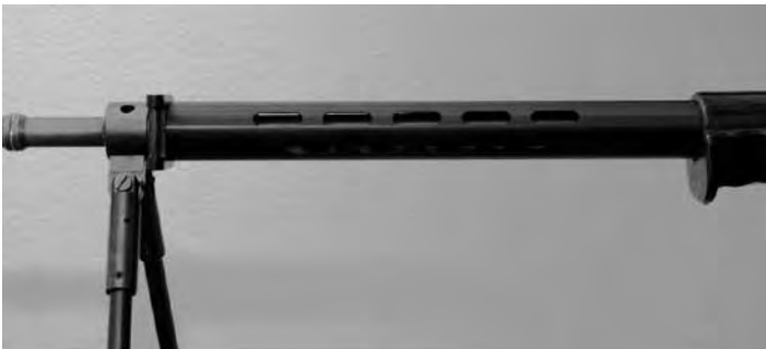
Bild 16: Mantelrohr zu Stgw 57
