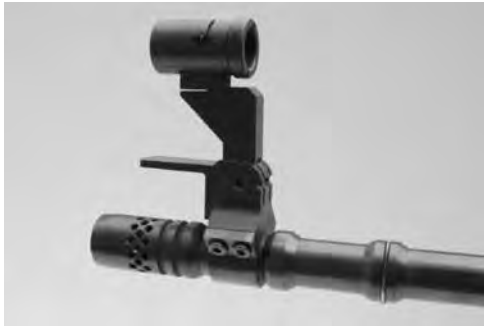
Bild 10: Kornträger als Visierverlängerung (Laufmontage), diverse Fabrikate
