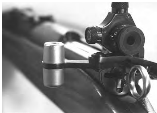
Figure 21: Verrou à gauche pour mousqueton 31
