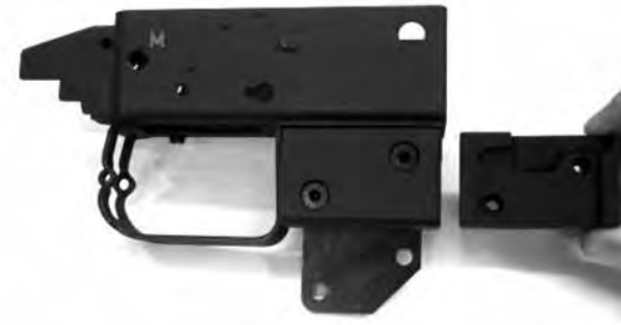
Figure 15: Adaptateur de poignée pour F ass 57
