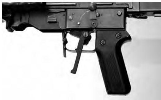
Figura 17: Grilletto ausiliario d'inverno per F ass 57
