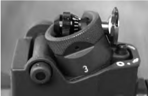
Bild 3: Irisblende zu Stgw 90 (mit und ohne Filter), diverse Fabrikate
