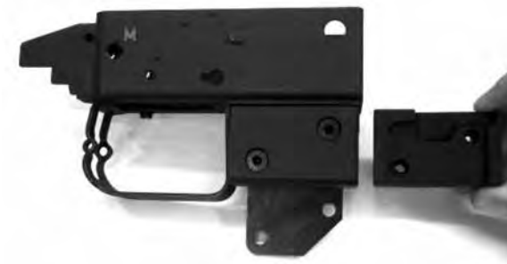
Figura 15: Adattatore per l'impugnatura a pistola per F ass 57
